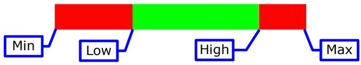
**Max** : Imposta il limite superiore (valore massimo visualizzabile) dell'indicatore pressione carburante.
