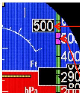
Indicazione numerica per regolare la posizione del bug di quota con la manopola. Scompare automaticamente dopo 3 secondi.
