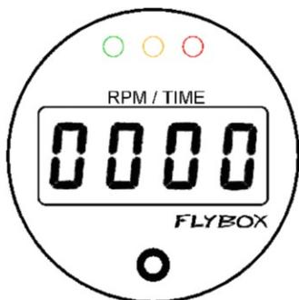
A motore spento il display mostra “0000” e i tre led sono spenti, mentre con il motore acceso viene visualizzato il numero di giri al minuto e contemporaneamente si accende uno dei tre led, per indicare in quale regime di rotazione si trova il motore:
