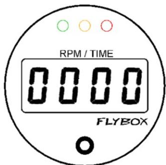
Premendo il pulsante compare il tempo trascorso dall'inizio del volo in ore e minuti; premendo nuovamente il pulsante o attendendo 5 secondi si torna al modo contagiri. Il valore massimo misurabile è 9 ore e 59 minuti.
