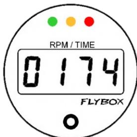
**3-** Indica il tempo totale di funzionamento del motore.
