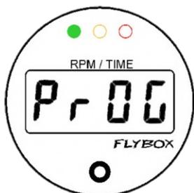
A questo punto si può inserire un valore numerico che verrà memorizzato nel contatore delle ore di funzionamento del motore in zona “verde” (e quindi anche nel contatore delle ore totali del motore).
