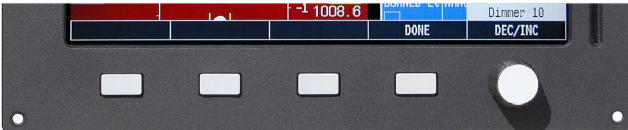
Ora è possibile regolare il valore della funzione selezionata ruotando la manopola (in questo caso ad esempio ruotando la manopola si regola la luminosità del display da 1 a 10). Premendo il pulsante P4 (DONE) si esce dalla funzione salvando il nuovo valore impostato con la manopola.
