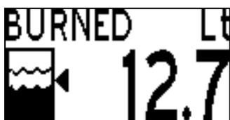
Indica il carburante consumato dalla messa in moto. A seconda dell'unità di misura impostata questo valore sarà visualizzato in litri (Lt) oppure galloni (USg).
