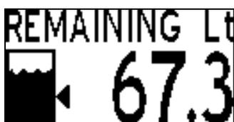
Indica la quantità di carburante rimasta nei/l serbatoi/o. A seconda dell'unità di misura impostata questo valore sarà visualizzato in litri (Lt) oppure galloni (USg).
