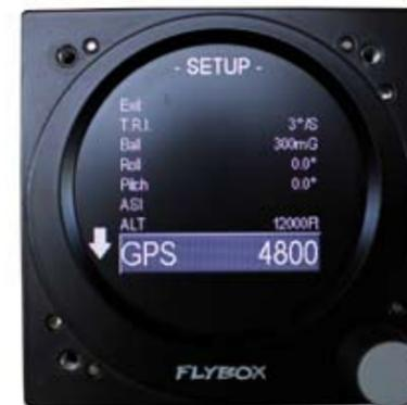
la sezione Setup consente di regolare le modalità di visualizzazione, la regolazione e la sensibilità delle varie funzioni EFIS
