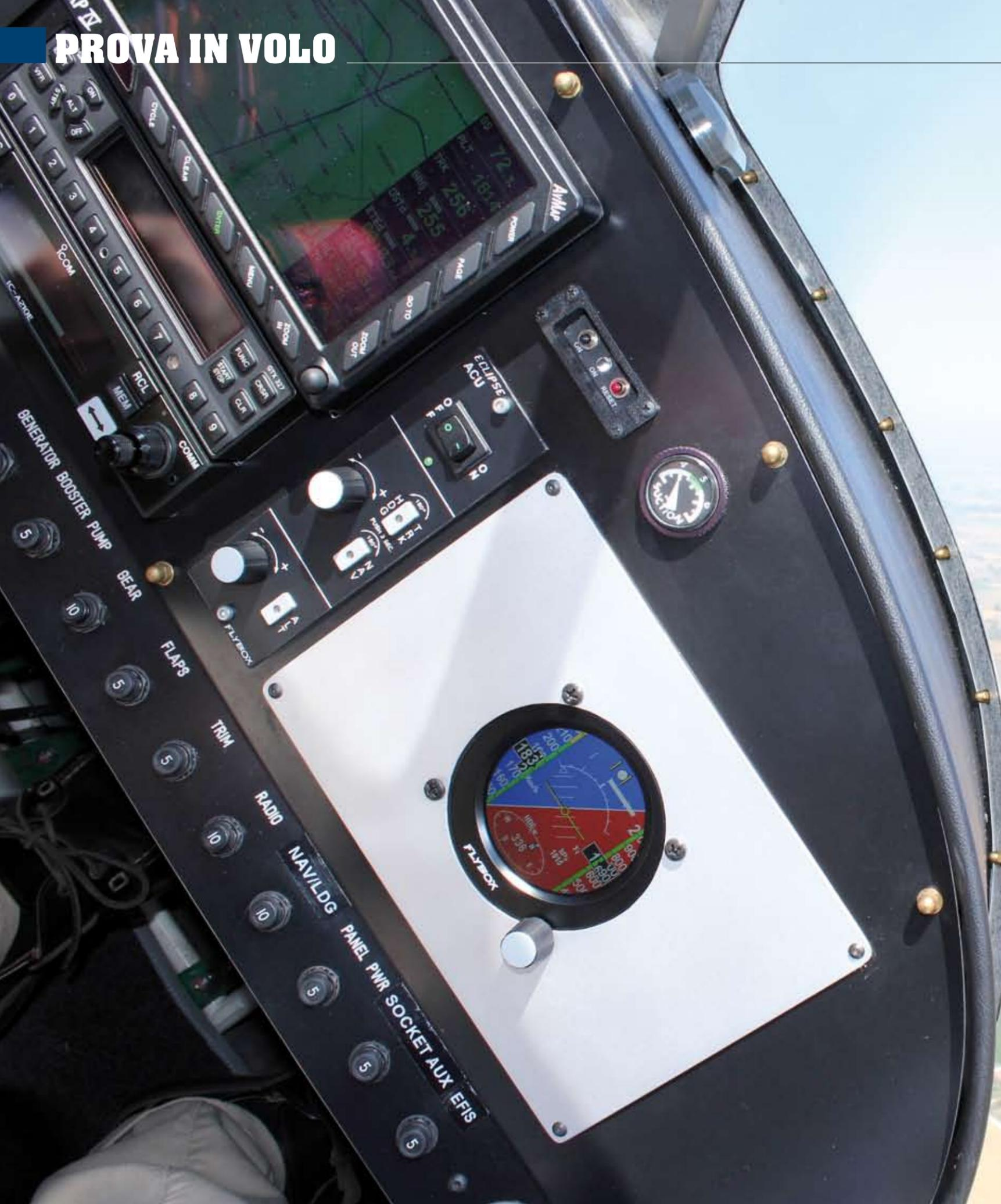
sentazione ovale nella parte bassa dello strumento) da Heading a Tracking nel caso lo strumento sia collegato a un GPS
