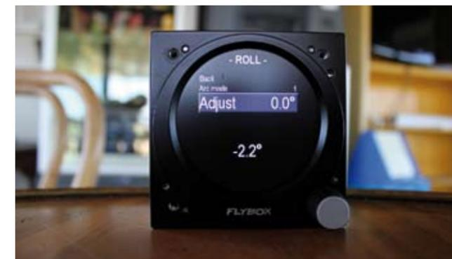
Su pitch e roll è possibile effettuare una calibrazione fine per compensare inclinazioni di montaggio o di assetto
