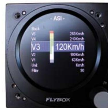
Il menu setup dell'anemometro consente di regolare i limiti degli archi colorati, l'unità di misura e la sensibilità di lettura
